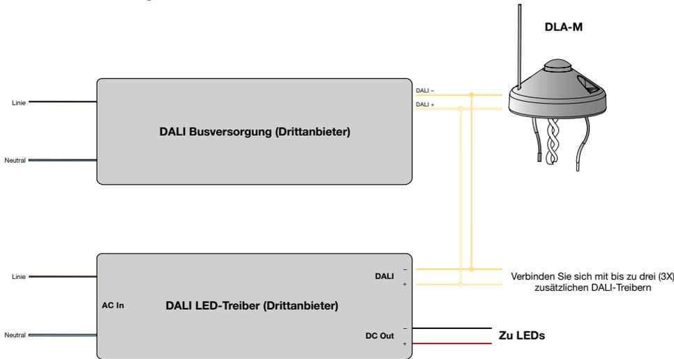
**Hinweis:** Verwenden Sie 18 to 22 AWG Verkabelung (0.82 to 0.33 m<sup>2</sup>)
