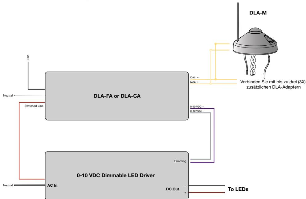
**Hinweis:** Verwenden Sie 18 to 22 AWG verkabelung (0.82 to 0.33 m<sup>2</sup>)
