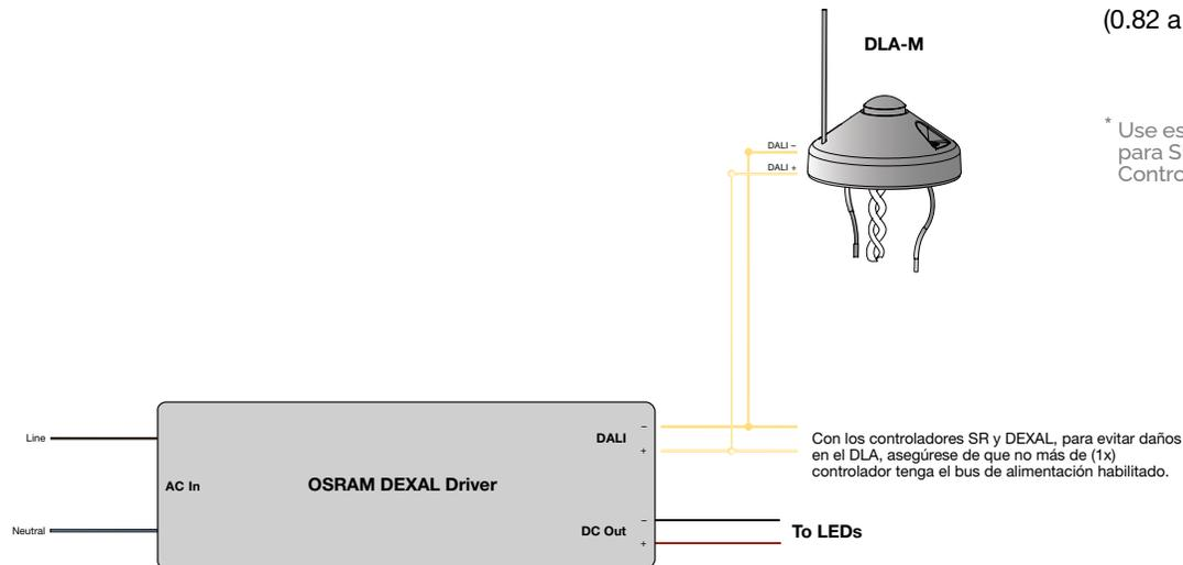
\* Use este método de cableado para SR Ready DALI y Philips® Controladores SR.
