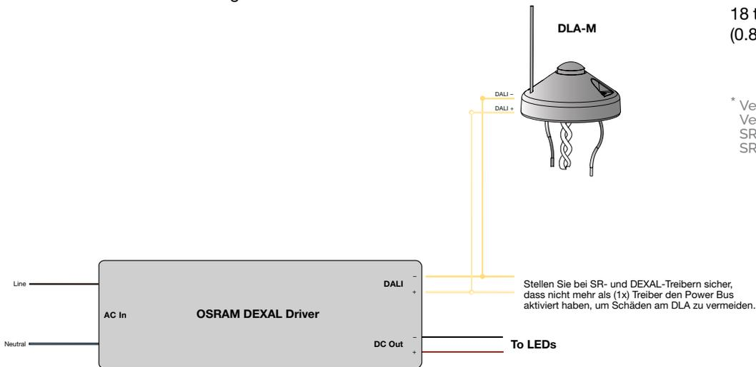
**Hinweis:** Verwenden Sie 18 to 22 AWG Verkabelung (0.82 to 0.33 m<sup>2</sup>)
